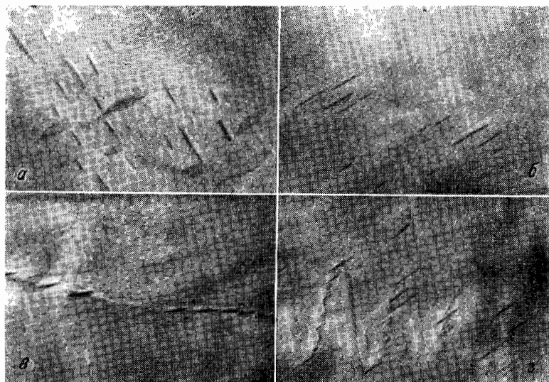
Рис. 4. Изменение структуры сплава Al+4% Cu, состаренного при 473 °K в течение 10 час (а), и во время изотермической выдержки при 453 °K в течение 1 (б), 5 (в) и 10 (г) мин
