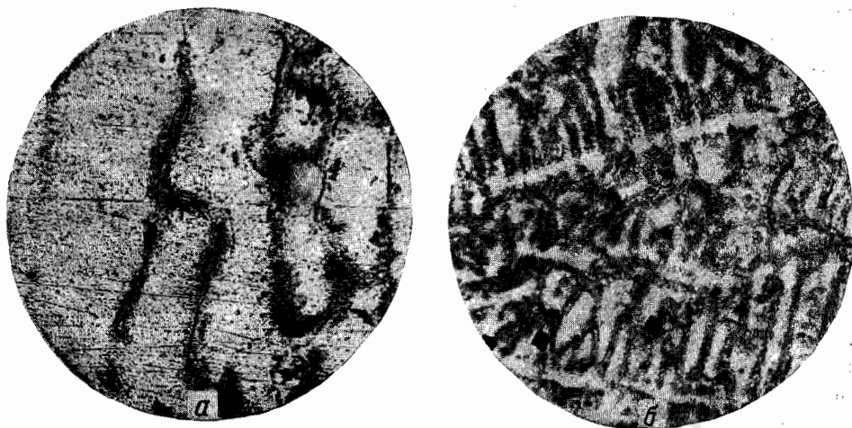
Рис. 10. Микроструктура сплавов Al — Cu + 0,5% Mg, отлитых в холодную изложницу и испытанных при 300^\circ
