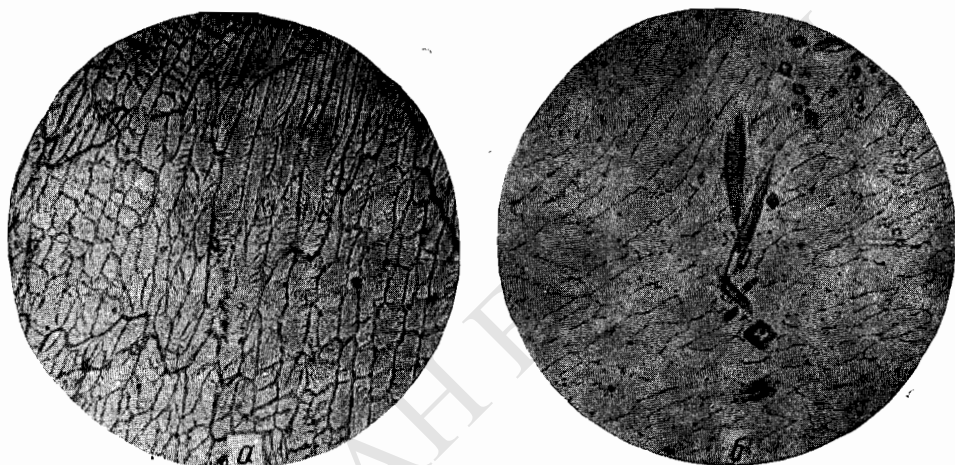
Рис. 7. Микроструктура литых в изложницу сплавов Al — Mn ( \times 90 ) а — 1,5% Mn; б — 2,5% Mn
