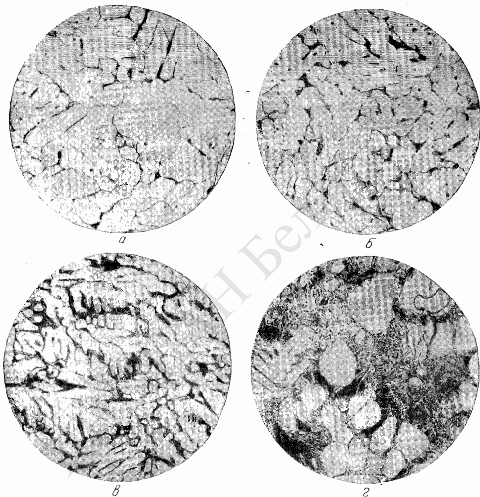
Рис. 2. Микроструктуры литых сплавов Al — Fe (отливка в холодную изложницу, \times 200 ) а — 0,5% Fe; б — 1,0% Fe; в — 1,5% Fe; г — 3,0% Fe
